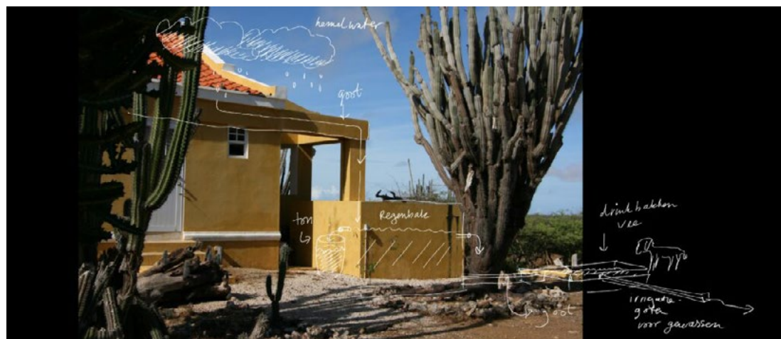
10. Het principe van regenwateropvang en distributiesysteem van het Bonairiaanse Landhuis Rooi (Foto: Jet Bakels. Bewerking LILA Living Landscapes)
